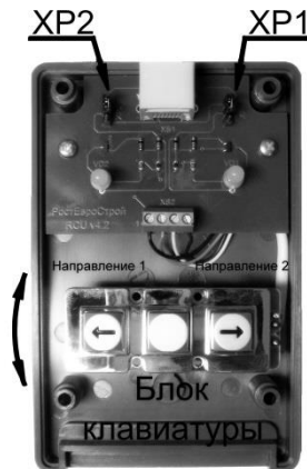
Вид пульта со снятой крышкой
